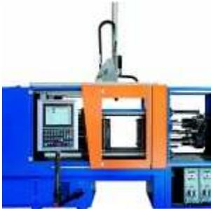
Vor allem bei zeitlich hintereinander liegenden, linearen Achsbewegungen ist eine hydraulische Antriebslösung mit nur einem Antriebssatz eine technisch und wirtschaftlich sinnvolle Lösung. In einer häufig eingesetzten konventionellen Konfiguration werden Volumenstrom und Systemdruck mittels verstellbarer Kolbenpumpe an einer Asynchronmaschine am Drehstromnetz geregelt.
