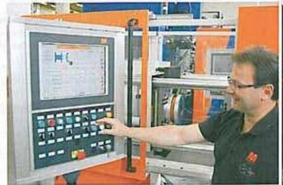
3: Bedienung und Diagnose mit Hilfe eines kundenspezifisch gestalteten AP900 mit 15-Zoll-Touchscreen von B&R
