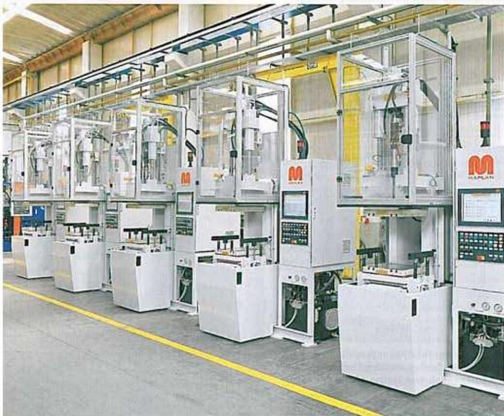
*Ein Drittel ihrer Energie verbrauchen Gummispritzgießmaschinen für den hydraulischen Antrieb. Durch Umstieg auf eine elektrohydraulische Lösung mit servogesteuerten Innenzahnradpumpen verminderte der Maschinenhersteller Maplan diesen Energieanteil auf ein Fünftel des früheren Wertes und senkte zugleich den Geräuschpegel um 50 %. Auch die ebenfalls erzielte Verkürzung der Trockenlaufzeit um 10 bis 15 % trägt zur Amortisierung der Anschaffungskosten in kürzester Zeit bei.*
