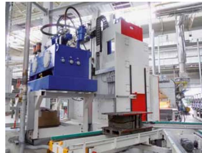
Die Servo-Antriebslösung von Siemens regelt den Öldruck der Anlage direkt über den am Motor angeschlossenen Sinamics-S120-Umrichter. Damit erreicht man eine Reduktion des elektrischen Energieverbrauches um bis zu 70 Prozent gegenüber Lösungen mit Asynchronmotoren.
