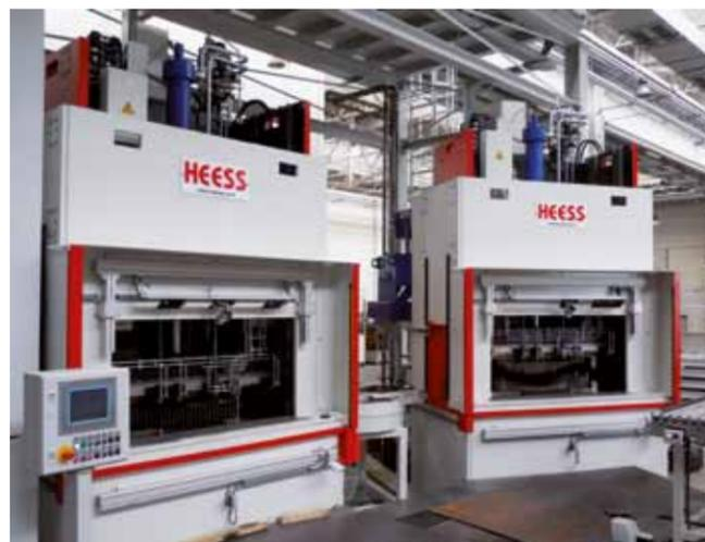
Der österreichische Landmaschinenhersteller Pöttinger setzt Heess-Härtemaschinen zur Warmumformung und Härtung von hochfesten Serien- und Verschleißteilen ein. Die Maschinen besitzen zwei hydraulische Hauptantriebe. Einen zum Verformen und Halten der Bauteile und einen zum Absenken der Werkstücke in das Abschreckbad.
